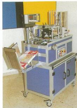
客先仕様によるプロファイルで構成されたカセットテープ印刷・穴あけ機
