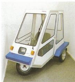
プロファイルでシャーシを組み立てた、軽自動車
