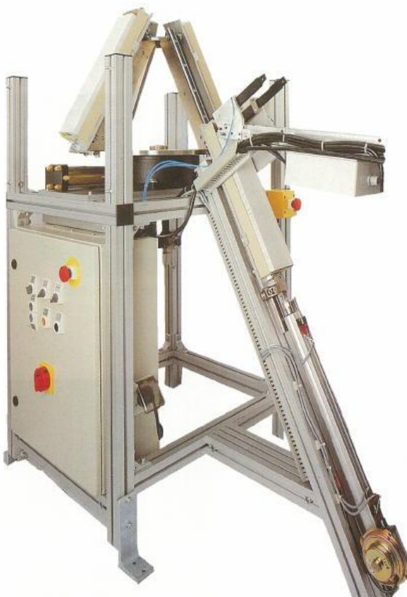
KANYA斜め鉗手を使った、アングルフィーダー付きクレジットカードテスト及び積上ロボット
