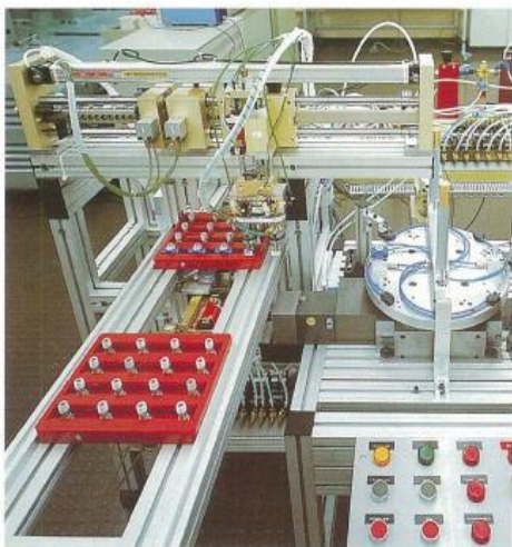
標準プロファイルで構成された、ハンドリングロボット・回転テーブルを含む、組み立てシステム
