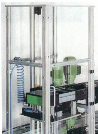
2分割平面リニアトランスファーシステムの 持ち上げ防護カバー
