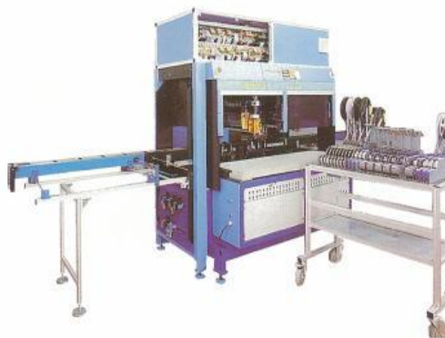
標準プロファイルで組み立てた、材料供給車と監視台付pcb組立装置
